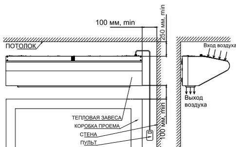
В задней стенке корпуса завесы имеются пазы для установки завесы (см. рисунок ниже). За эти пазы завеса навешивается на предварительно смонтированный в стену крепеж. В качестве крепежа рекомендуются шурупы или болты с диаметром шляпки от 9 до 11 мм. Установочные размеры завес приведены в таблице ниже. Также завесу можно установить горизонтально, используя кронштейны см. схемы ниже.
