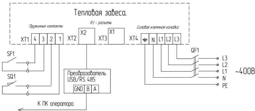
Управление занавесами осуществляется с помощью выносного проводного пульта управления Ballu BRC-D. Также есть возможность управления с помощью ПК. Схема группового подключения приведена на стр. 11.
