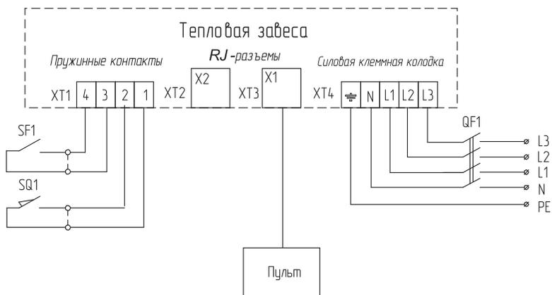
XT1 – пружинная клеммная колодка кросс платы;
