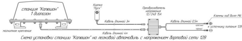
Схема установки станции "Копюшон" на легковой автомобиль с напряжением бортовой сети 12В
