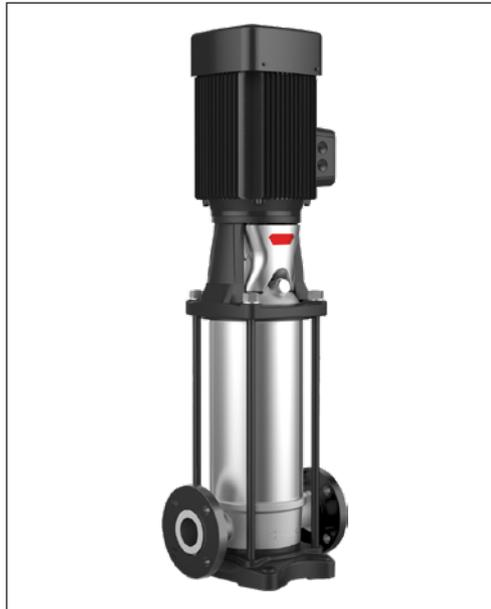
Насосы RMV являются многоступенчатыми насосами со всасывающим и напорным патрубками одинакового размера, расположенными на одной оси. Такая схема обеспечивает более компактную конструкцию насоса. Насосы поставляются в различных типоразмерах и с различным количеством ступеней для обеспечения требуемого расхода и давления.
