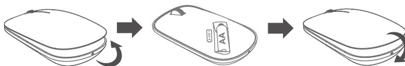
Откройте верхнюю часть корпуса по метке на задней части мыши, вставьте батарею AA в батарейный отсек и закройте верхнюю часть корпуса.
